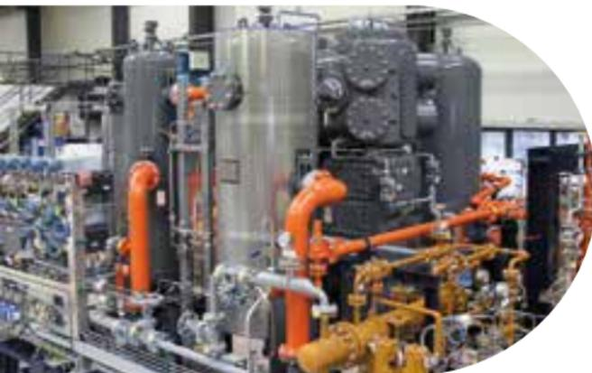
Kolbenverdichter für Wasserstoff
