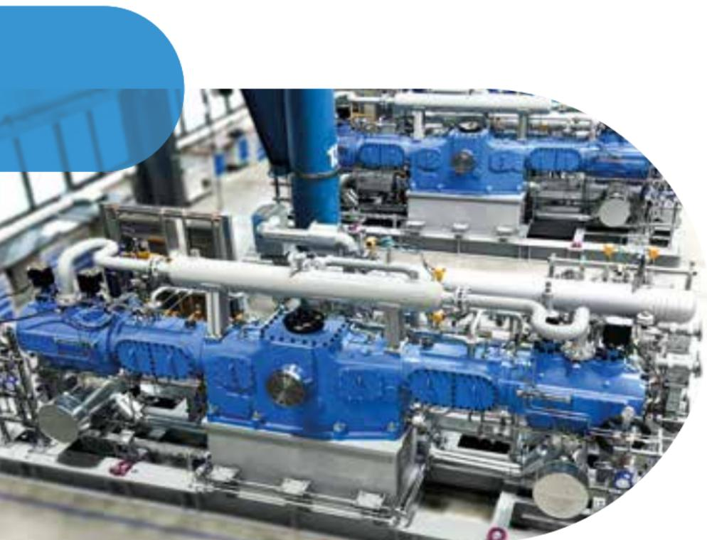
Kolbenverdichter für Wasserstoff
