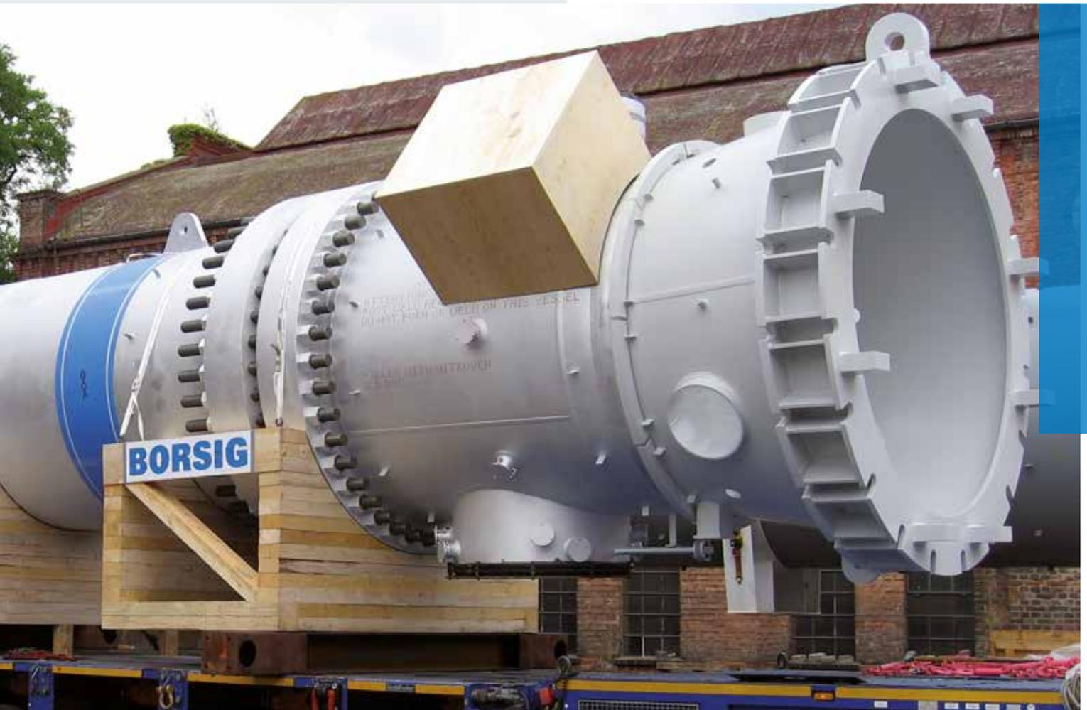
Es können Abhitzekekessel mit einem gasseitigen Durchsatz bis zu 70.000 Nm<sup>3</sup>/h gebaut werden.
